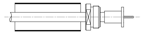
STEP 4- SLIDE THE WASHER ON THE CENTER CONDUCTOR AND PUSH IT AGAINST THE BRAID CLAMP. SLIDE THE INNER CONTACT ON THE CENTER CONDUCTOR AGAINST THE WASHER. CRIMPING THE INNER CONTACT WITH M22520/1-01(RADIALL 282 291) CRIMPING TOOL SELECTOR 7, POSITIONNER M22520/1-13(RADIALL 282 997) RED TURRET.
