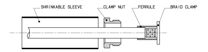
STEP 3- THEN CUT THE DIELECTRIC FLUSH WITH BRAID CLAMP.
